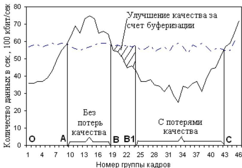
РИС. 1. Изменение скорости битового потока видеоизображения (проигрывания) и пропускной способности сети. Пунктирной линией обозначена скорость проигрывания, сплошной линией – пропускная способность сети
