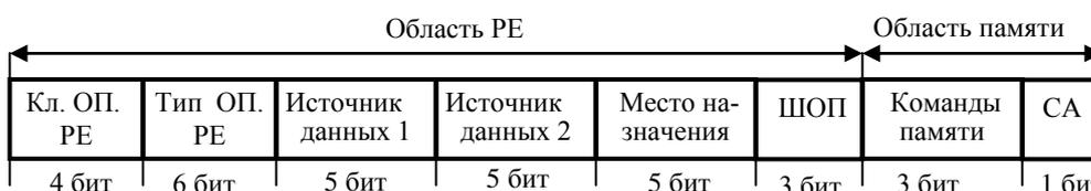
РИС. 5. Базовый формат скалярных команд гипотетической РИМ-системы
