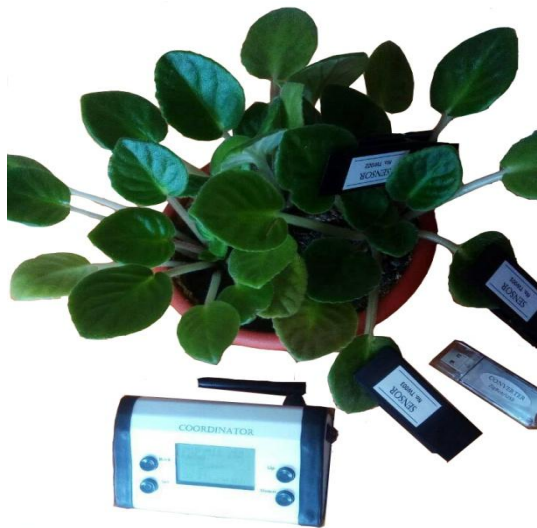
РИС. 1. Фотографія зразка вузлів мережі бездротових біосенсорів
